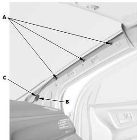
4. 断开天线引线插接器 (A), 然后拆下线束夹 (B)。
