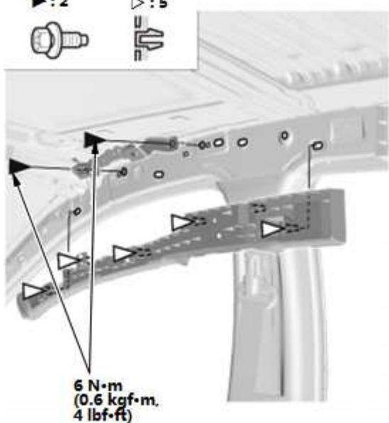
1. 不带侧窗帘式气囊：如有必要，拆下钩和螺栓。
